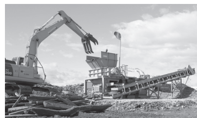
東日本大震災でがれき処理に使用した二軸剪断式破碎機。来年度中には全機種に遠隔監視システムを標準搭載
