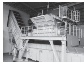
導入した大型破碎機
