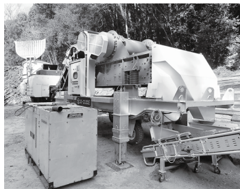
振動ふるいやベルトコンベアを一体化した近畿工業製K-CUBE。移動可能な特性を活かし、ワコー産業では(写真奥)移動式破碎機と組み合わせて広範囲での木屑処理を行っている
