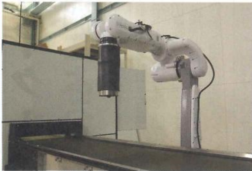
「V-PICKER」吸着タイプ(写真上)と磁着タイプ(写真下)
