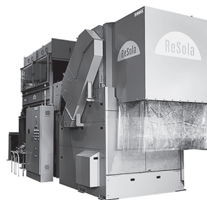
太陽光パネルリサイクル処理設備「ReSola(リソラ)」
